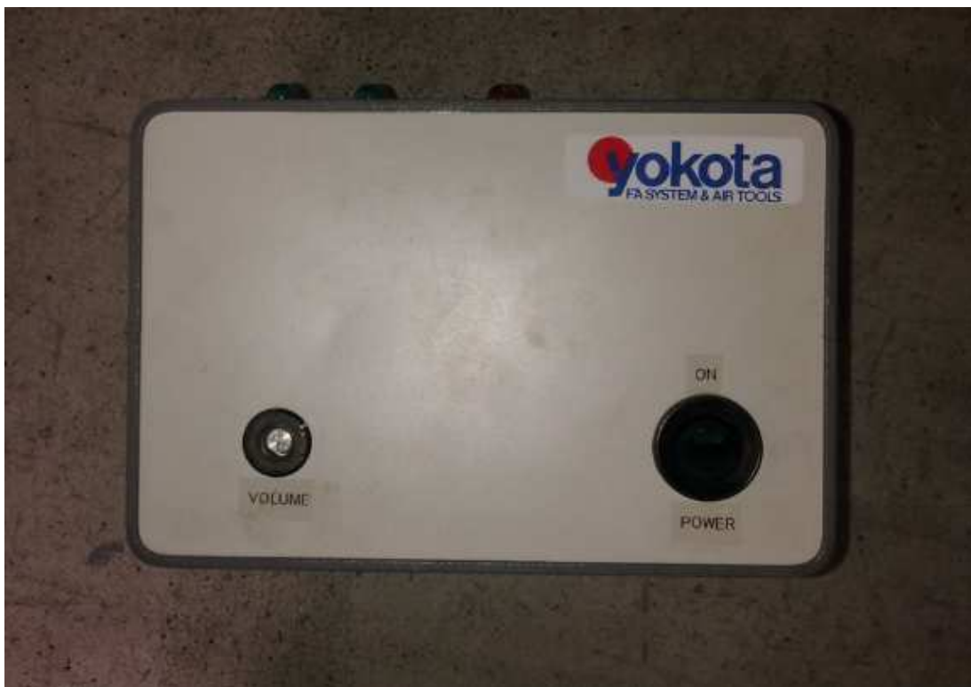
Riadiaca jednotka Poka Yoke YOKOTA typ YPSC-1 v prevádzke
