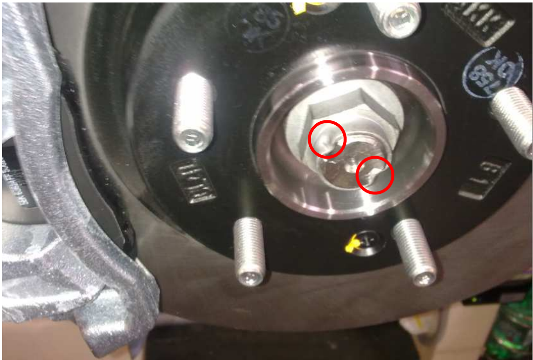
Zaistenie matíc náboja kolies osobných automobilov po zaskrutkovaní.
