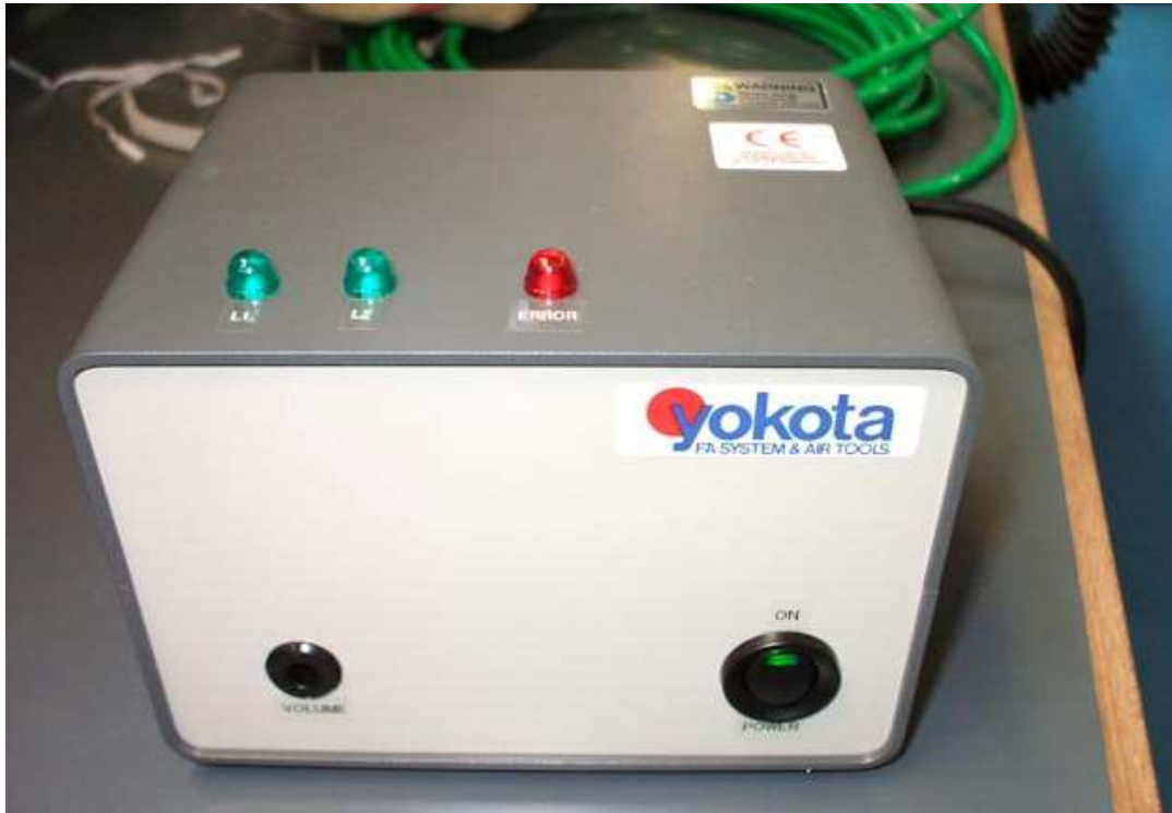
Riadiaca jednotka Poka Yoke YOKOTA typ YPSC-1 pred uvedením do prevádzky
