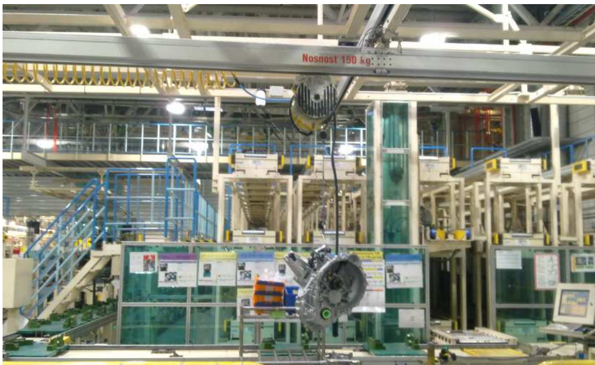
Detailný pohľad na pneumatický balansér so zaveseným bremenom.
